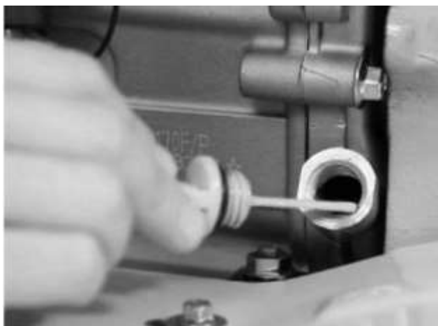
Fig. 5 – Verificarea nivelului de ulei la motor
